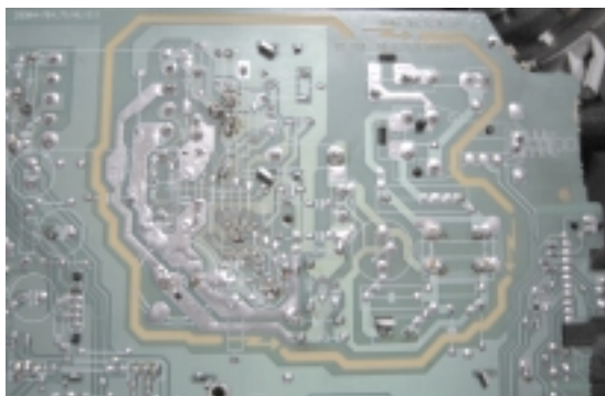
Fig. 8.2. Detalle del área viva de un circuito.
