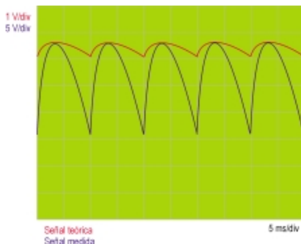
Fig. 8.14. Señales teórica y real en la salida del filtro.
