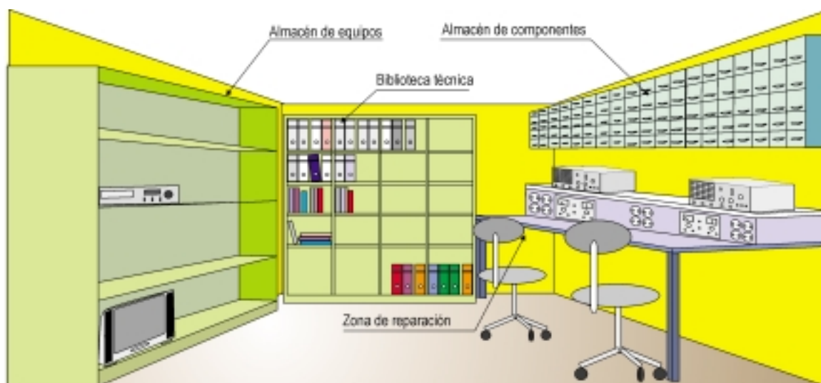
Fig. 8.1. Distribución de un taller de reparación.
