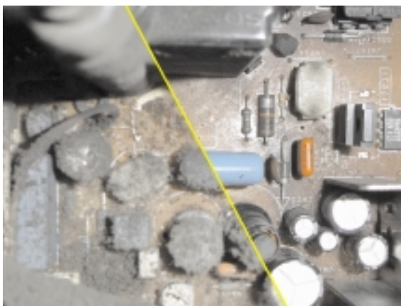
Fig. 8.11. Estado de un circuito impreso antes y después de la limpieza.
