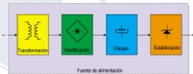
Fig. 8.13. Subbloques de una fuente de alimentación.
